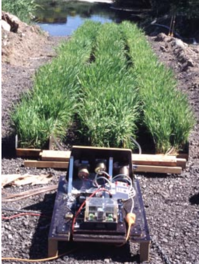
De tre parallella översilningsrännorna med fördelningspumpar uppställda ovanför lakvattendammen på Hagby återvinningsanläggning.
